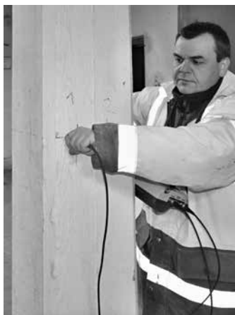
Obr. 9 Provádění ultrazvukového měření na sloupech
