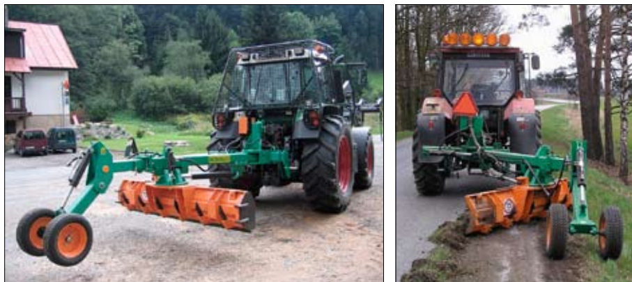
Obr. 25: Nesený grejdr za traktor – hobl. (Foto: http://www.agrowest.com/produkty/nopo-zm-slatinany-otocne-radlice/grejdr-herkules-super/ ).
