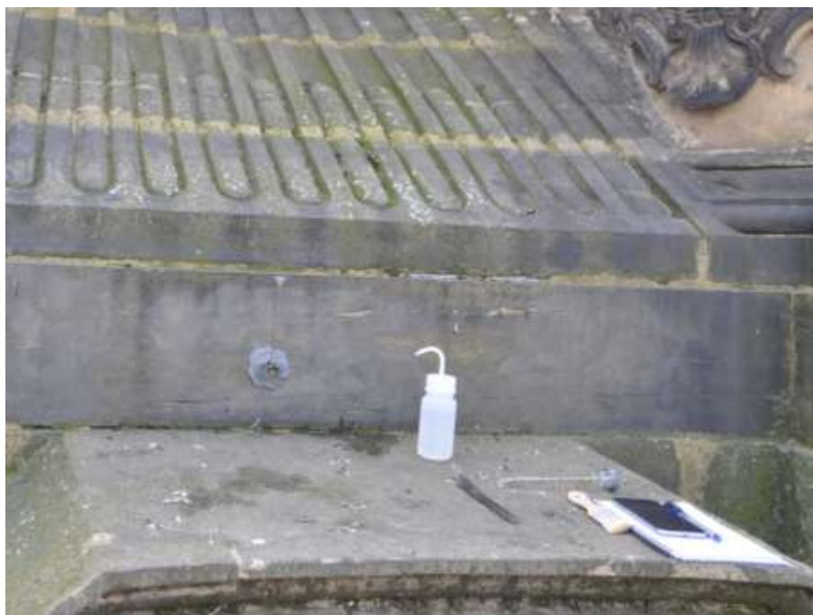
Obrázek 3: Měření nasákavosti pomocí Karstenovy trubice v místech nad římsou druhého patra architektury
